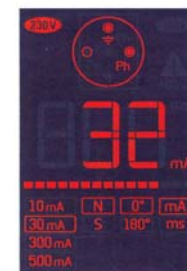
Пример определения величины тока срабатывания
